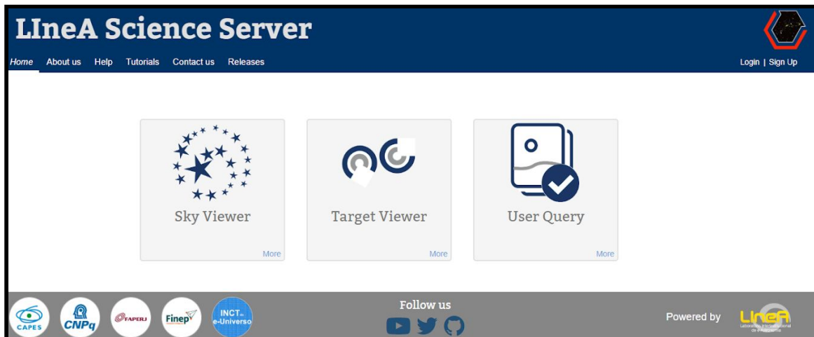
Figura 12 - Interface do LIneA Science Server disponível no NCSA que permite a visualização de imagens ( Sky Viewer ), superposição de lista de objetos (exportada para o NCSA do portal científico ou gerada por buscas no banco de dados) sobre as imagens ( Target Viewer ) e realização de buscas no banco de dados gerando listas de alvos ( User Query ) que podem ser visualizadas com o Target Viewer .
